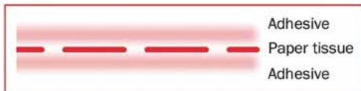
PRO DMT est un tissu de montage activé par la chaleur. La base en tissu est respirante et généralement réversible à la chaleur. Le polymère adhésif est appliqué en utilisant un procédé de revêtement thermofusible à haute viscosité. Aucun solvant n'est utilisé.
